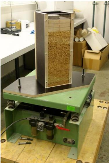
Abb. 3. Versuchsanlage zur Bestimmung des Setzungsverhaltens
