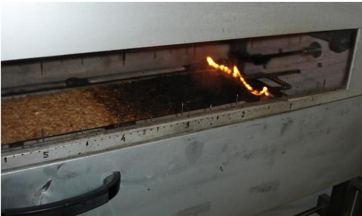
Abb. 5. Radiant Panel Test. Rechts Lineburner mit nach links laufender Flammfront (Bild: Rechsteiner)
