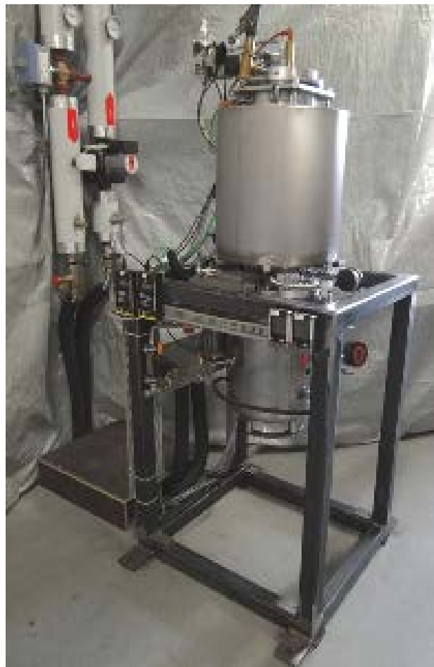
Figure 11 : Moteur Stirling résonant à piston libre de la société Rudolf Schmid
