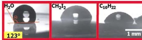
**Abbildung 6:** Kontaktwinkel von zwei polaren (Wasser und Dijodomethan), und einer unpolaren Flüssigkeit (Dekan, ein kurzkettiges Öl) auf der Perfluorosilanschicht.
