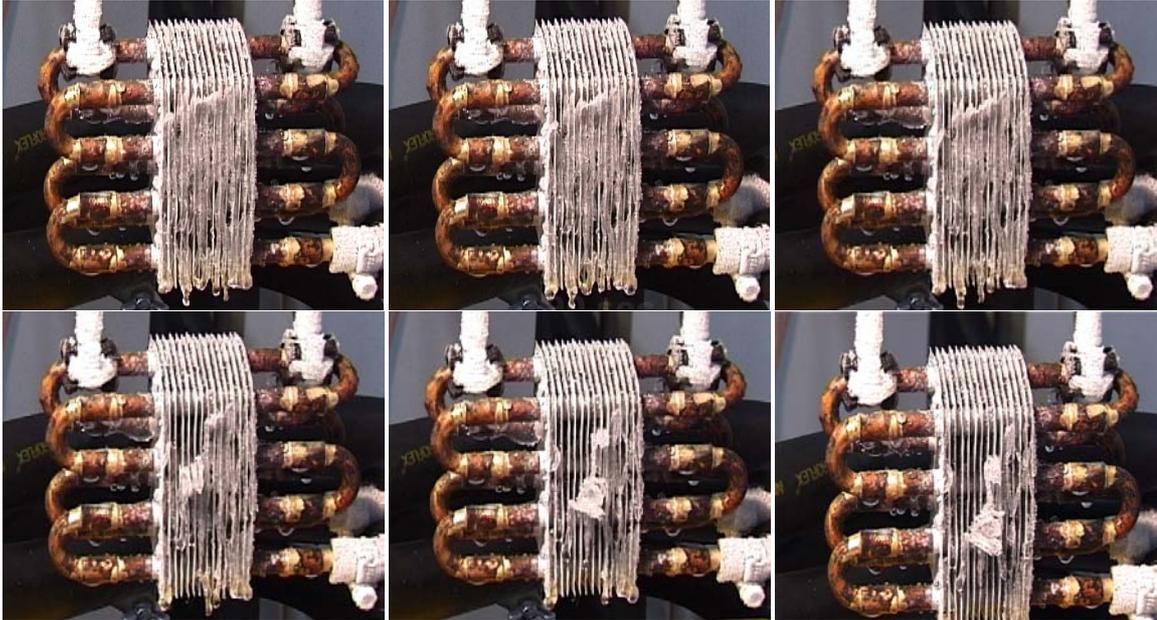
**Abbildung 17:** „LOTUS“ Wärmetauscher, Abtauphase zwischen 90 - 105 s
