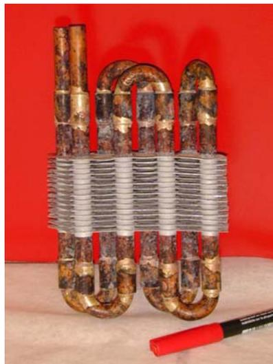
**Abbildung 14:** Kleinwärmetauscher aus 15 Aluminium-Lamellen 10x13cm, 8 Kupferrohre.
