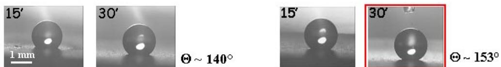
**Abbildung 11:** Links: Perfluorosilanisiertes Aluminium mit saurer Sol-Gel Schicht, gezeigt ist der statische Kontaktwinkel von Wasser. Rechts: Perfluorosilanisiertes Aluminium mit basischer Sol-Gel Schicht.
