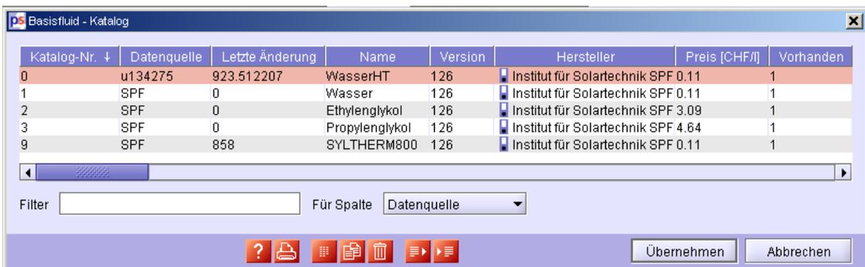
**Abb. 2:** Definition von neuen Wärmeträgermedien im Basisfluid Katalog von Polysun4.
