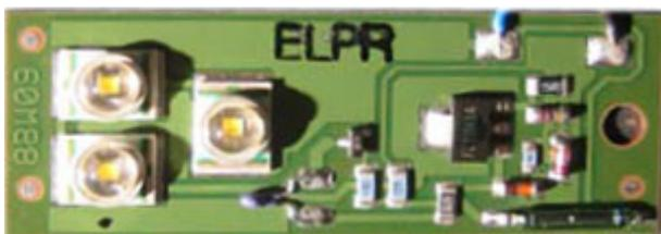
Abbildung 14: Print mit drei 1-Watt-Power-LEDs
