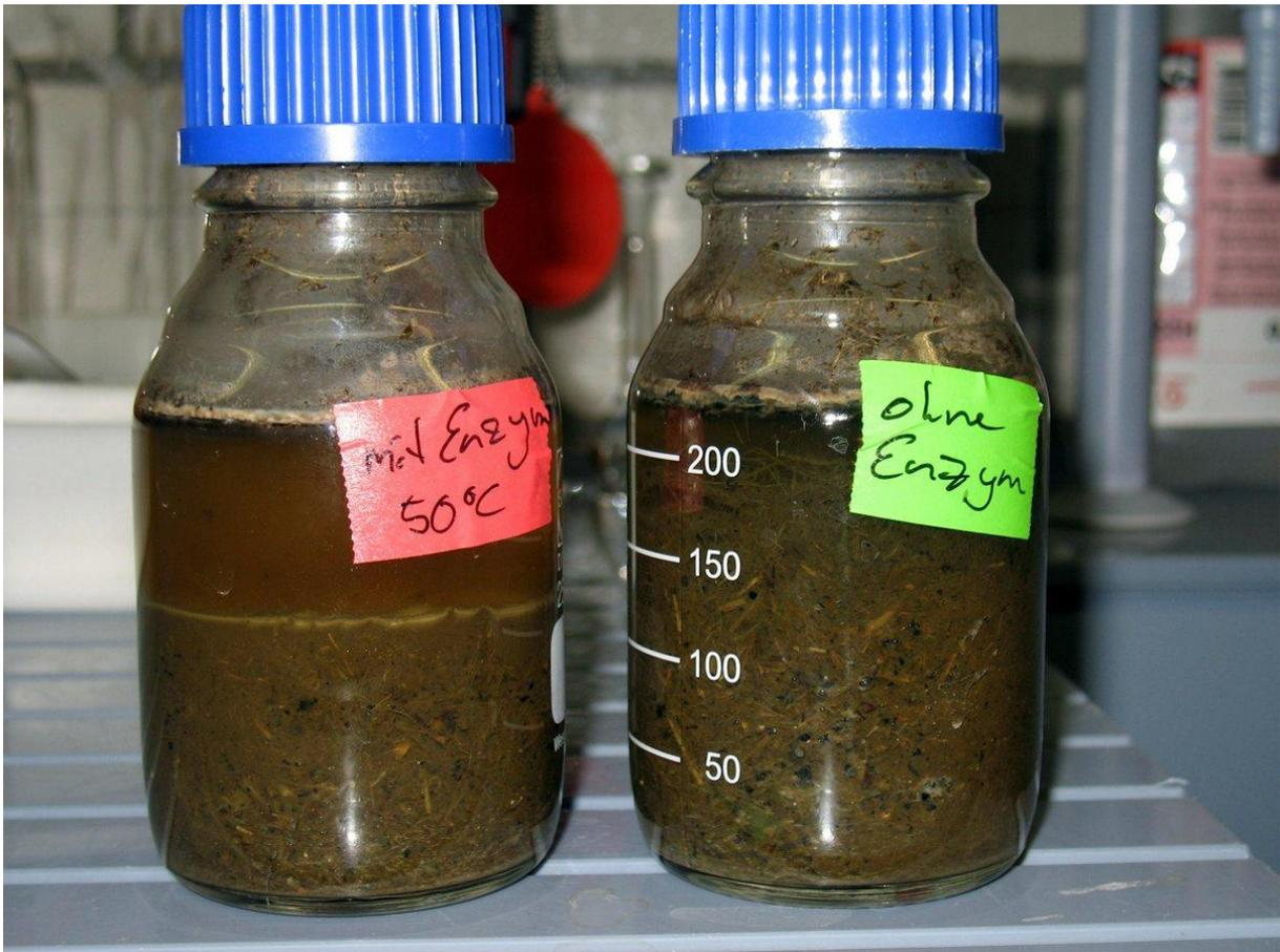
**Abbildung 18:** Inkubation von Gras-Silage mit hydrolytischen Enzymen (eingesetzte Produkte: H, Cellulase + Y Hemicellulase). Nach 15 h Inkubationsdauer mit hydrolytischen Enzymen bei 50 °C ist bereits mit dem blossen Auge ein Unterschied von den behandelten zu den unbehandelten Ansätzen sichtbar.
