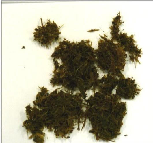
**Abbildung 6:** Feststoffe der Rindergülle nach thermischer Behandlung. Diese Fraktion hat einen Trockensubstanz Anteil von ca. 20%, d.h. sie besteht noch zu 80 % aus Wasser. Bildausschnitt = 20 cm Breite.
