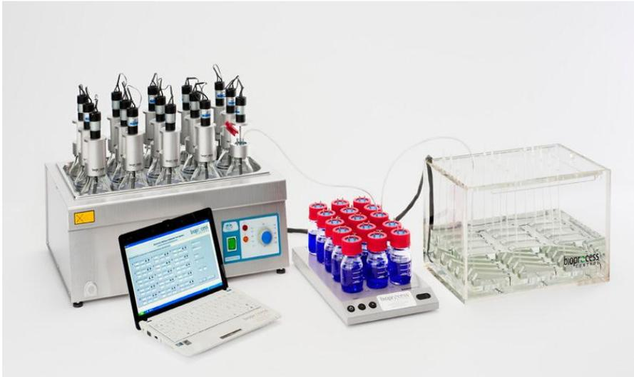
**Abbildung 2:** AMPTS-1 Apparatur zur Bestimmung des Langzeit-Methanpotentials (GB<sub>21</sub>). Foto: Bioprocess control
