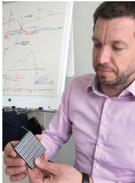
Dr. Corsin Battaglia untersucht am Materialforschungsinstitut Empa thermoelektrische Anwendungen beispielsweise zur Stromgewinnung aus Autoabgasen. Im Bild zeigt Battaglia einen kommerziell angebotenen thermoelektrischen Generator auf der Basis von Bismuttellurid. Foto: B. Vogel
