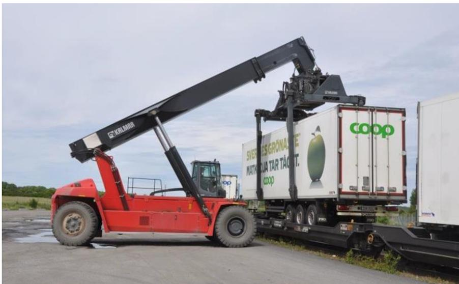
Abb. 3.4 Intermodales Verladen eines Sattelanhängers in Bro mit Hilfe eines Reachstackers (TFK)
