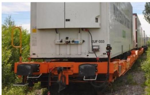
Abb. 3.7 Mit Drehstromkabel angeschlossener Sattelanhänger (TFK)
