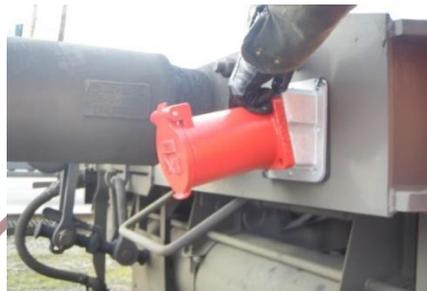
Abb. 5.2 Steckdose nach APTA-Standard mit möglichem Platzring auf intermodal Wagon (TFK)
