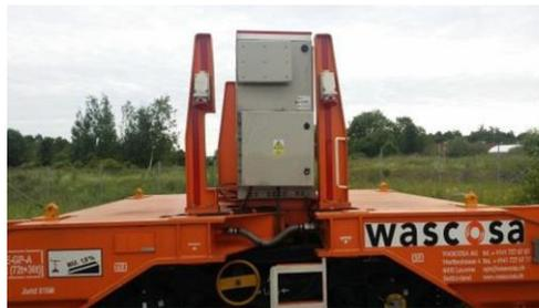
Abb. 3.6 Stromaggregat und Umrichteraggregat (TFK sowie Coop Logistik)
