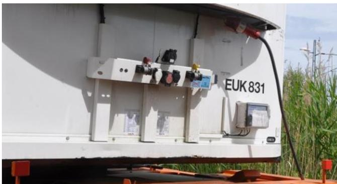
Abb. 3.11 Anschlusskabel, vom Vorderende des Ladungsträgers gesehen (TFK)
