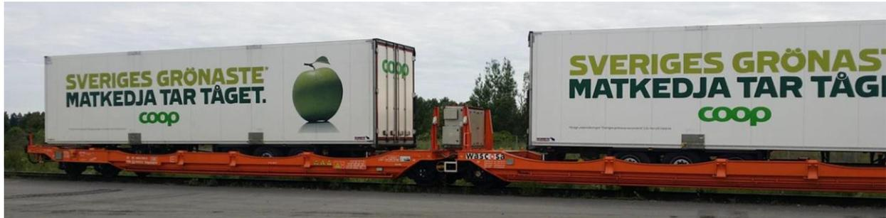
Abb. 3.5 Intermodaler Wagen mit Umrichteranlage und Stromversorgungsanlage, beladen mit zwei temperierten Sattelanhängern (Coop Logistik)
