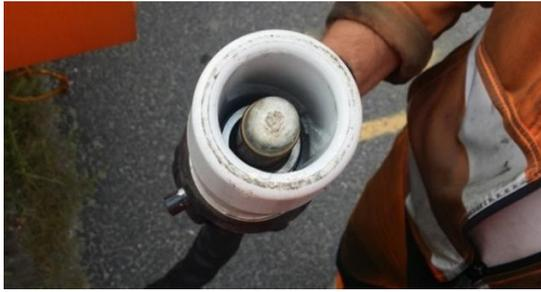
Abb. 3.8 Anschlusskontakt für einpolige Heizleitung
