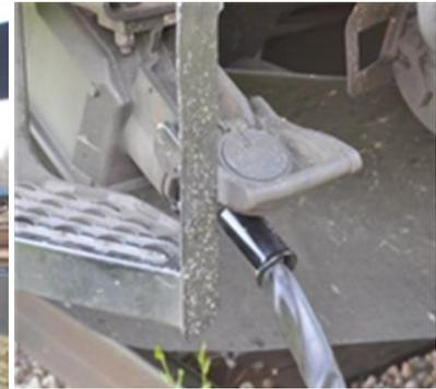
Abb. 2.7 Heizspannungsbuchse an TRAXX-Lok in Nahaufnahme (TFK)
