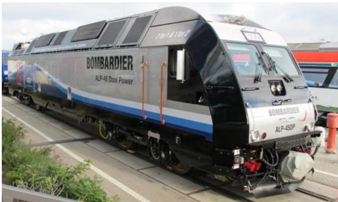
Abb. 2.4 Duo-Lok für Verkehr in Nordamerika mit Dreiphasenanschlüssen (rote Dosen) an der Frontseite (TFK)
