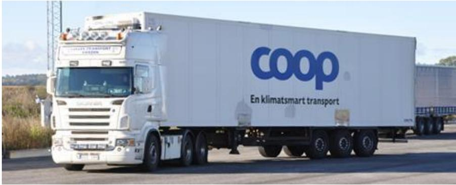
Abb. 3.3 Dreiachsige Zugmaschine mit Sattelanhängen (TFK)
