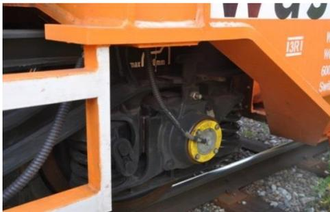
Abb. 3.9 Rückstromkontakt an Eisenbahnwagen (TFK)
