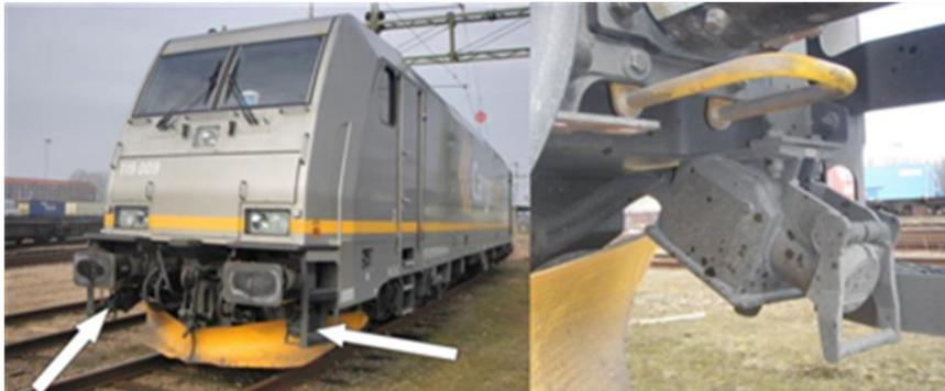
Abb. 2.6 TRAXX-Lok (CargoNet Ce 119) mit Buchse für Zugheizung (mit Pfeilen markiert) (TFK)
