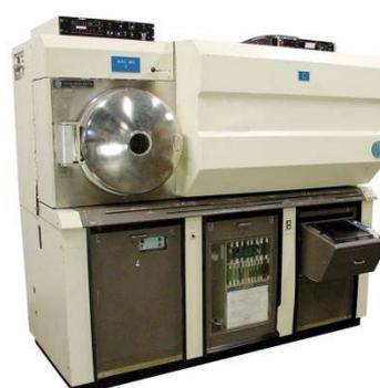
**Figure 2:** Installation MRC de sputtering pour le dépôt des contacts sur la face avant et au dos des cellules solaires CIGS de 30 x 30 cm<sup>2</sup> en couches minces (Source: EPFZ)
