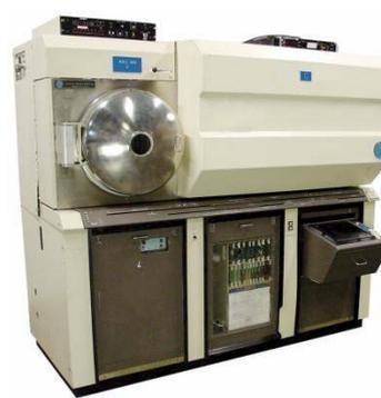
**Figur 2:** MRC Sputteranlage zur Abscheidung der Front- und Rückkontakte in 30 x 30 cm<sup>2</sup> CIGS Dünnschicht Solarzellen (Bildquelle: ETHZ)
