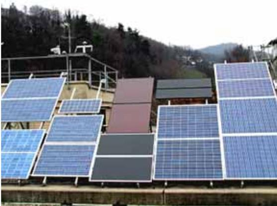
**Figur 6:** TISO PV Modulteststand
