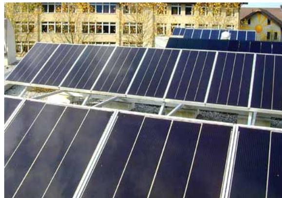
**Figur 37:** 3x1 kWp Testanlagen Newtech Burgdorf
