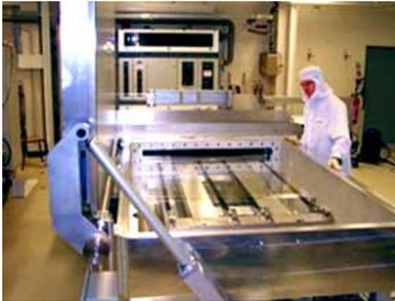
**Figur 1:** Industrielle Plasma KAI-Depositionsanlage (Bildquelle Unaxis)
