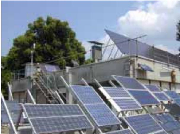
Bild 3: Teststand für Modulprüfungen am LEEE-TISO
