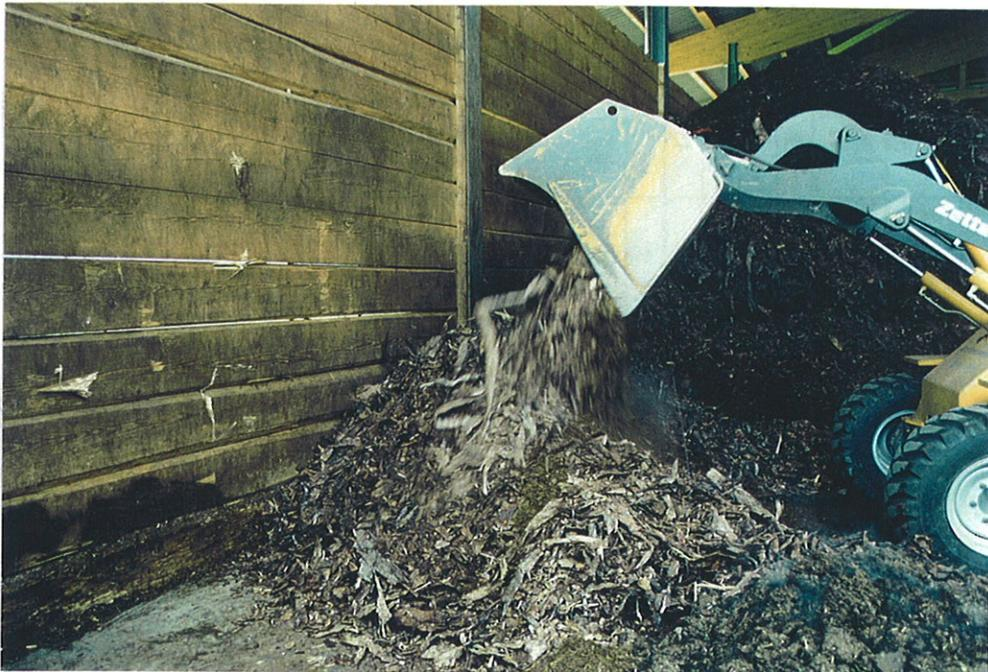
Abbildung 13: Mischen des Zusatzbrennstoffes (Hofdünger und Zuschlagstoffe) mit dem Hauptbrennstoff Rinde
