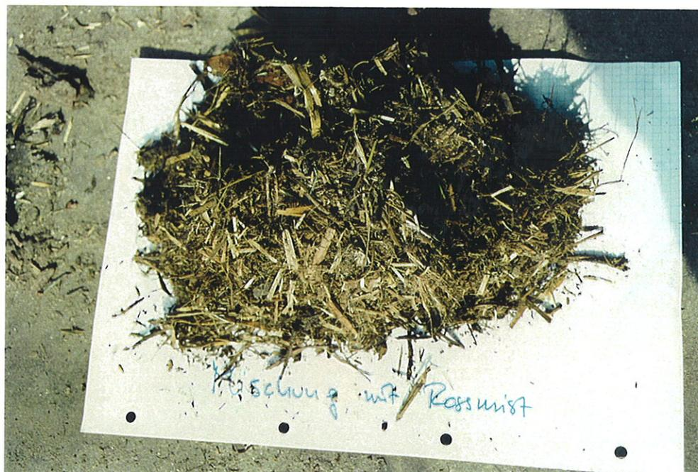
Abbildung 9: Brennstoffmischung mit Pferdemist
