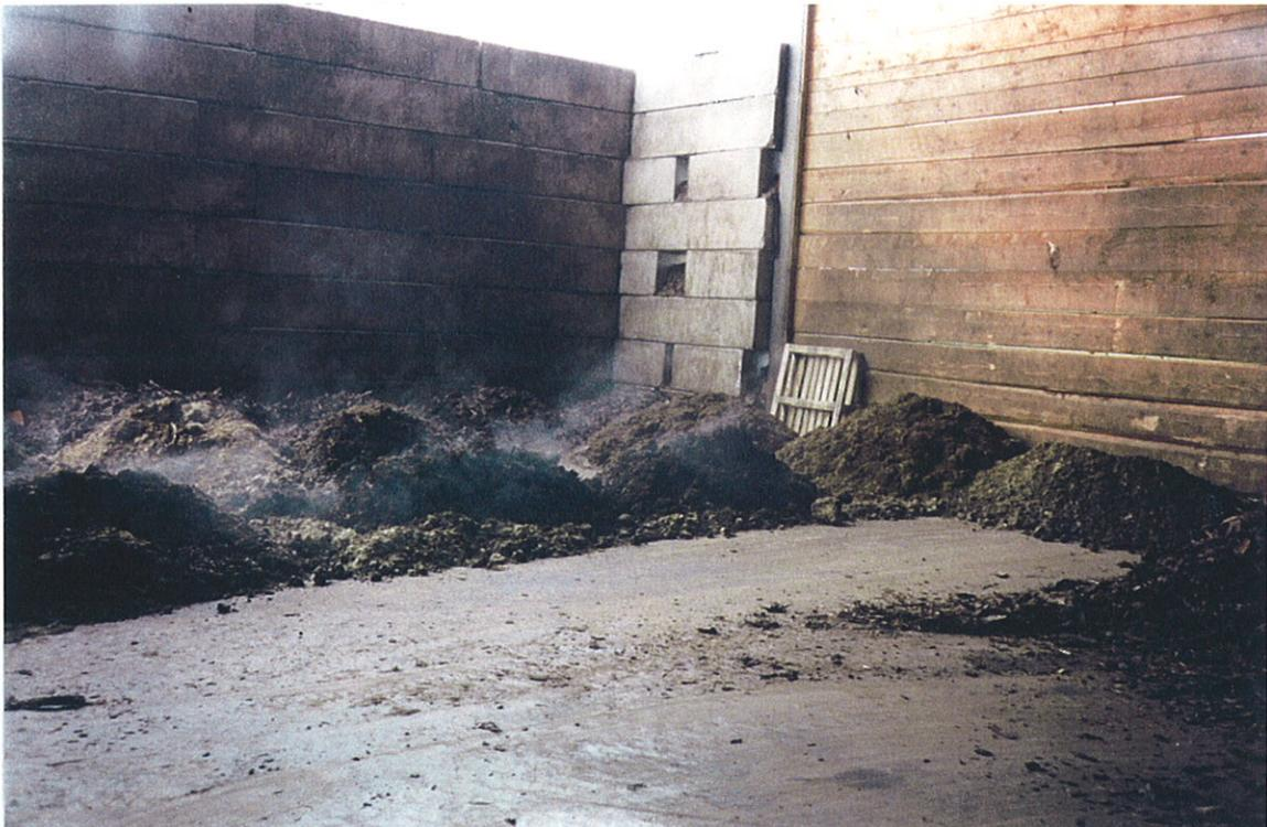
Abbildung 10: Erwärmung (Dampfbildung) der Brennstoffmischungen
