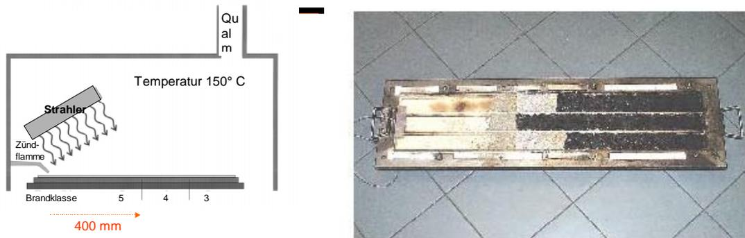
Abbildung 1: Schema des Radiant Panel Tests (links). Proben nach dem Test (rechts). Quelle: EMPA SG und IBF AG.
