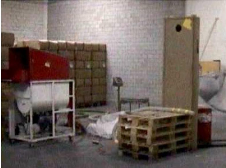
Abbildung 3: Grosskistenelement (stehend) zur Prüfung des Einblasverhaltens.
