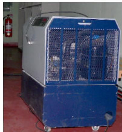
Die Abbildung rechts zeigt das geöffnete Lüftungsgerät mit seinem elektrischen Antrieb. Die Antriebsleistung ist umschaltbar zwischen 0.75 kW und 2.2 kW.
