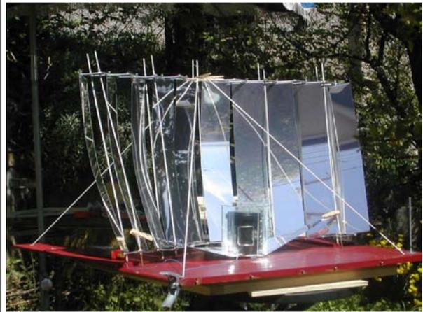
**Résultat des tests:** La focale est très précise pour les miroirs 2-9, les miroirs 1 et 10 sont difficile à focaliser. Puissance mesuré maximale de 102W. Tests de cuisson concluants.
