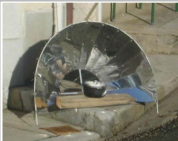
**Résultat des tests:** Difficile de garder la forme stable. La parabole se déforme sous son propre poids (structure en fibre de verre). 1/3 de la lumière arrive à l'extérieur de la focale. Adaptation aux différentes angles (hauteurs) du soleil ok.
