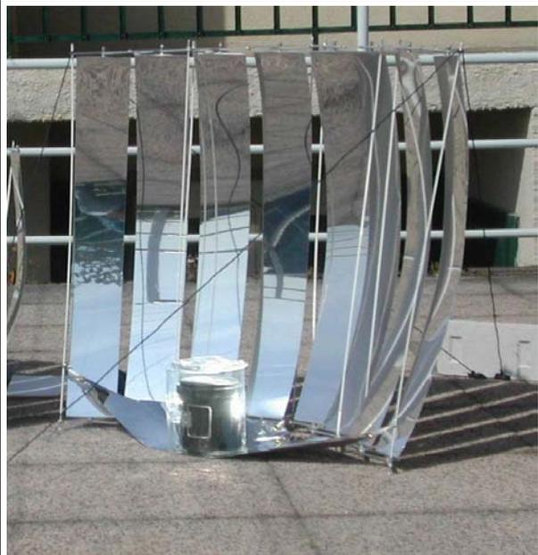
**Résultat des tests:** La focale est très précise. Puissance mesuré maximale de 86W. Tests de cuisson concluants. Le cache en polycarbonat peut se déformer dû à la forte chaleur.
