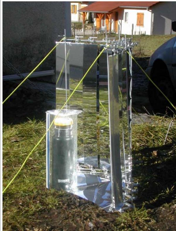
**Résultat des tests:** Réflecteur assez stable, avec des ficelles bonne stabilité au vent. Puissance mesuré en janvier 2005 = 77W, pertes de la casserole en janvier, sans paravent = 34W. Focale très précise entre 30° et 60° (azimut). Après 60 minutes sans correction des réglages, encore 50% de la lumière tombe sur la casserole.
