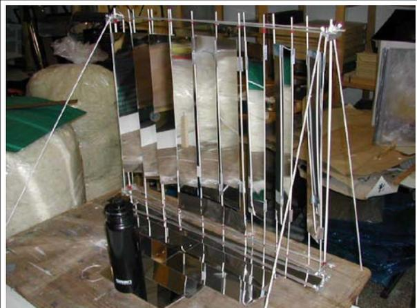
**Résultat des tests:** Focale assez imprécise. Les 4 éléments extérieurs ne servent à rien; la distance entre la casserole et les miroirs est trop différente. Le miroir horizontal fonctionne bien. Le simulateur des saisons fonctionne bien.
