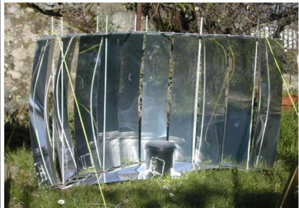
**Résultat des tests:** La focale est très précise pour les miroirs 4,5,6 et 7. Les miroirs 1 et 10 ne servent à rien, les miroirs 2,3,8 et 9 sont difficile à focaliser. Puissance mesuré maximale de 85W<sup>2</sup>.
