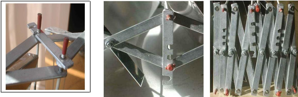
*Abbildungen 5-7. Einstellhaken mit Langlöchern (v.l.n.r.): Die Version von 2005, die Version 2006 bei geöffnetem Kocher, die Version 2006 bei (fast) zusammengefaltetem Kocher.*
