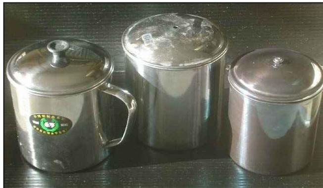
Abbildung 1. Von links nach rechts: Der original Edelstahltopf, der Topf ohne Griff und Plastikteile, der hitzebehandelte Topf.
