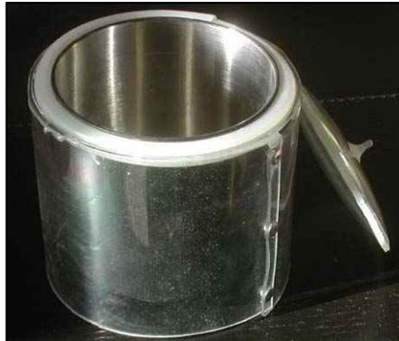
Abbildung 3. Der im Windschutz hängende Topf (äusserer Ring = Polycarbonat).
