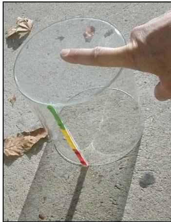
*Abbildung 13. Windschutzhaube mit Farbskala zum Ablesen der Einstrahlhöhe der Sonne (Der Schattenwurf des Fingers bestimmt, welche Farbeinstellung gilt.)*
