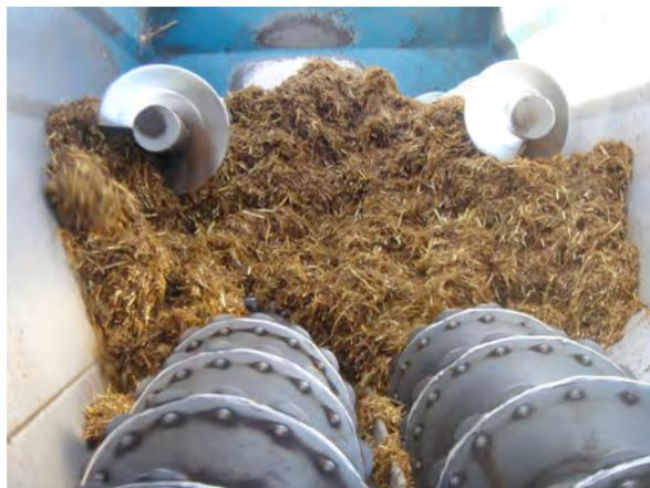
Abbildung 7 Herstellung der Brennstoffmischungen im Futtermischwagen
