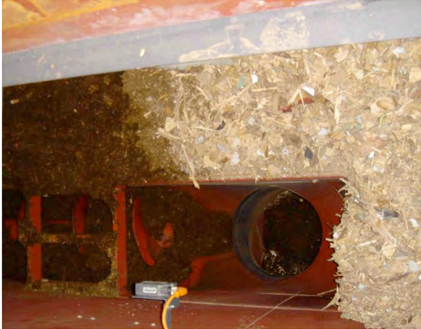
Abbildung 4: *Blick von oben in den Mischschacht. Links die Schnecke, gefüllt mit Pferdemist; rechts die Queraustragung des Hauptbrennstoffes Hackschnitzel.*
