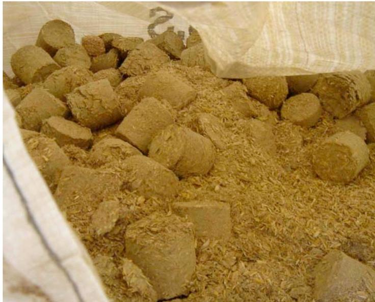
*Abbildung 8:* Getreidebruch, angeliefert in Big-bags in Form von lose gepressten Briketts. Schon im Big-bag ist ein grosser Teil der Briketts in Staub zerfallen
