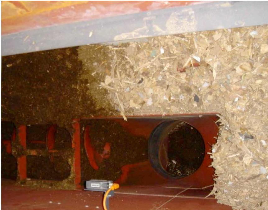
Abbildung 5: Blick von oben in den Mischschacht. Links die Schnecke, gefüllt mit Pferdemist; rechts die Queraustragung des Hauptbrennstoffes Hackschnitzel.
