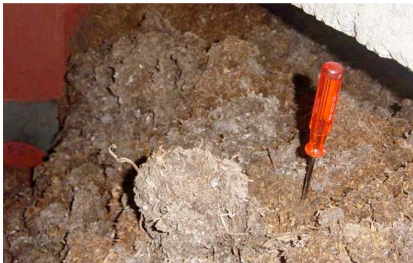
*Abbildung 9:* Pilzkompost. Der Brennstoff ist von weisslich gefärbt, wahrscheinlich verursacht durch den Zuschlagstoff Gips. Im Klumpen im Vordergrund gut sichtbar, wie das Grundmaterial mit Pilz-Mycel durchsetzt ist
