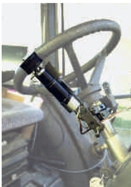
Fig. 9: Guidage directement sur le volant de direction : à gauche Trimble EZ-Steer, au centre John-Deere AutoTrac Universal, à droite prototype d'Agroscope Reckenholz-Tänikon.
