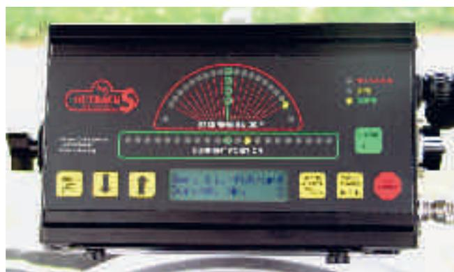
Fig. 8: Systèmes de guidage parallèle manuels avec indicateur lumineux: à gauche Centerline 220 de LH Agro, à droite Outback 5 d'Agrocom.
