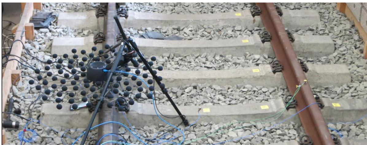
Abbildung 2-2: Messungen des Schwellenschalls mittels Mikrofonarray BionicM
