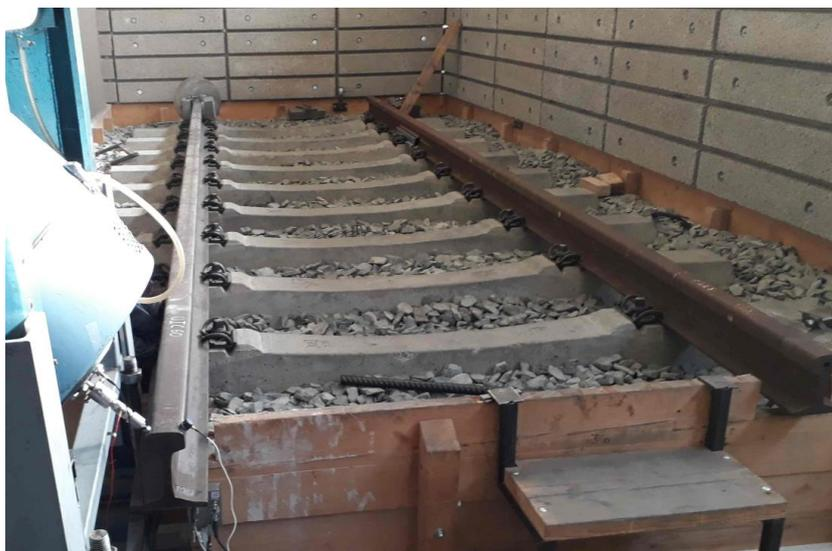
Abbildung 2-1: Testgleis Schrey und Veith in Sprendlingen mit elektrodynamischen Shaker an der linken Schiene
