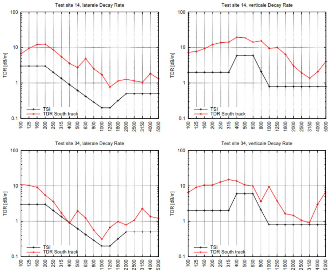
Abbildung 2-4: TDR von Messstelle 14 und 34 (Gerade) mit B91 und UIC60 Oberbau, Quelle: sonRAIL Projektdokumentation Teil 2
