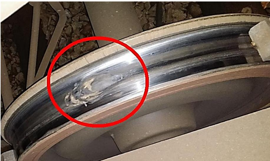
Abbildung 25: Messdatenbeispiel: Detektierte Flachstelle
