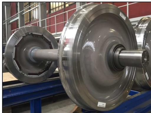
Abbildung 2: Laufradsatz der BA 308 inkl. Radschallabsorber VICON RASA RSI und Beschichtung Relest@SA NG
