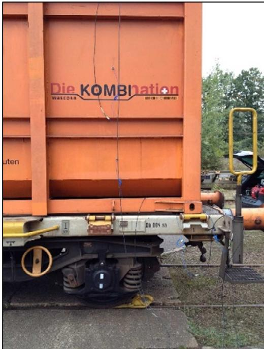
Abbildung 13: E-Behälter-Impedanzmessung – Messorte
