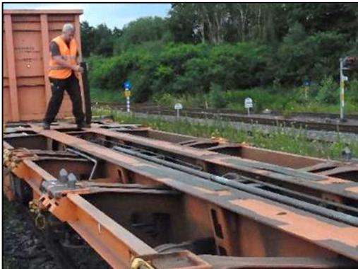
Abbildung 23: Auslegen der Elastomerstreifen (dunkelgrün) auf den zwei CTW-Längsträgern
