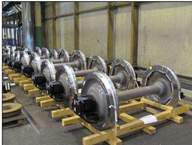
Abbildung 6: Montierte RS fertig zur Auslieferung
