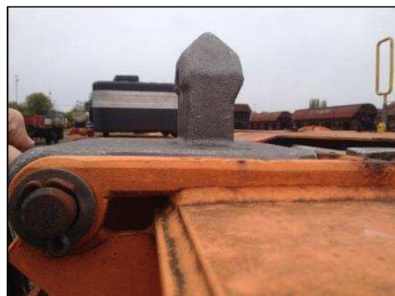
Abbildung 22: Einbauprobe Containerzapfen – Seitenansicht
