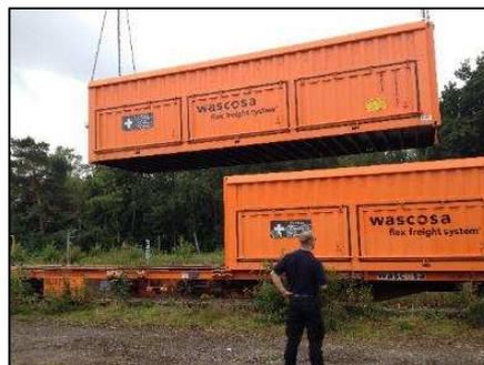
Abbildung 49: Umsetzen der 30'-E-Behälter
