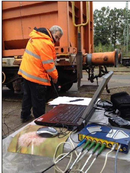
Abbildung 14: E-Behälter-Impedanzmessung – Messaufbau
