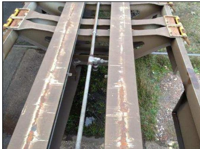
Abbildung 18: Spuren der E-Behälter-Kontakte auf Längsträger
