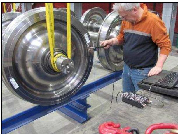
Abbildung 7: Messung der RS-Impedanz
