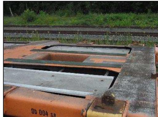
Abbildung 24: Elastomerstreifen (dunkelgrün) auf CTW-Längsträgern
