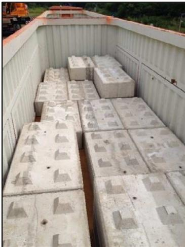
Abbildung 46: Geladene Bestensteine - die Seitenwände werden nicht berührt
