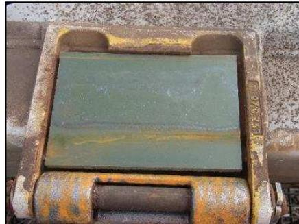
Abbildung 45: Elastomer unter Containerzapfen
