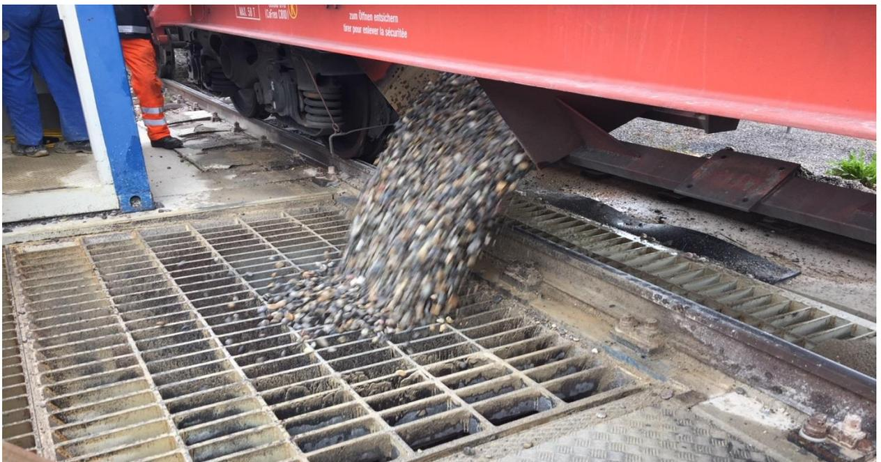
**Abbildung 3: Entladevorgang, Grube abgedeckt durch Metallrost**
