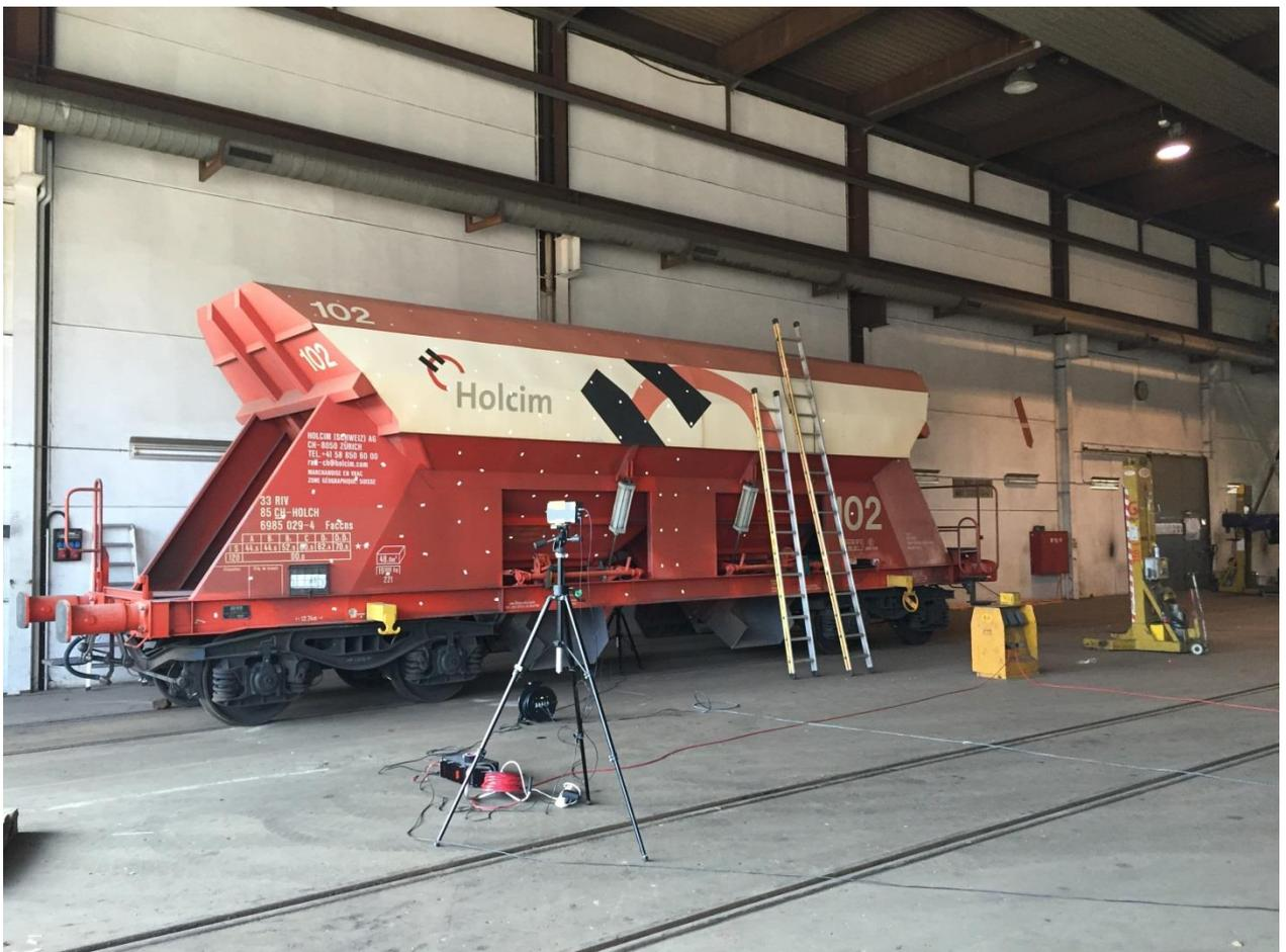
**Abbildung 1: Wagen Nr. 102 bereit für die Untersuchung des Körperschallfeldes bei Josef Meyer Rail**
